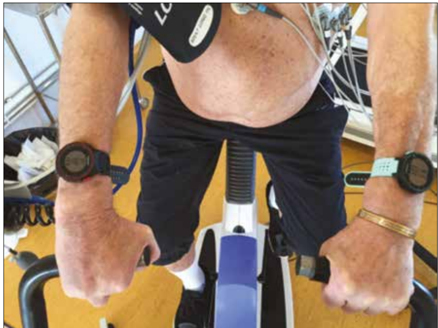
>>> Figure 2 - Exemple de test comparatif avec un CFM "tout-en-un" sur chaque poignet et un signal ECG en direct. Les deux CFM sont de la même marque, mais équipés l'un d'un capteur MIO et l'autre d'un capteur "maison".
