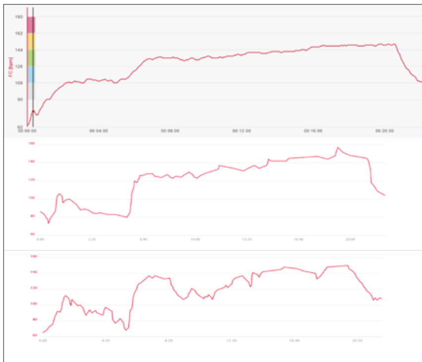
>>> Figure 6 - Comparaison des évolutions de la fréquence cardiaque (FC) relevées simultanément sur un CFM ceinture (en haut) et deux CFM "tout-en-un", nouvelle (au milieu) et ancienne (en bas) génération chez un sujet qui court (20 min) sur un tapis roulant sur une terrasse extérieure avec une température de 7-8 °C. Outre les variations brutales et inexpliquées des FC, noter l'inertie d'acquisition de la FC avec les CFM "tout-en-un" (variabilité plus marquée avec appareil ancienne génération).
