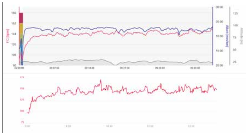
>>> Figure 5 - Séance de course à pied à vitesse stable (37 min) en sous-bois (15 °C). Haut : en bleu vitesse (min/km), en rouge fréquence cardiaque (FC) avec un CFM avec ceinture (variabilité < 5 bpm). Bas : recueil simultané de la FC avec un CFM "tout-en-un" avec écart majeur parfois des valeurs (cf. 15 e minute, variation proche de 20 bpm).
